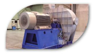
Bei der mechanischen Brüdenkompression wird der entstehende Brüden (Sattdampf) eines Verdampfers mit Hilfe eines Ventilators auf einen höhe ren Druck verdichtet und als Heizdampf dem Verdampfer wieder zugeführt. Der Ventilator arbeitet somit als Wärmepumpe.
